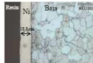
Gambar 9. Lapisan deposit nikela Watts-sitrat yang diamati pada mikroskop optik pada arah *cross section*.
